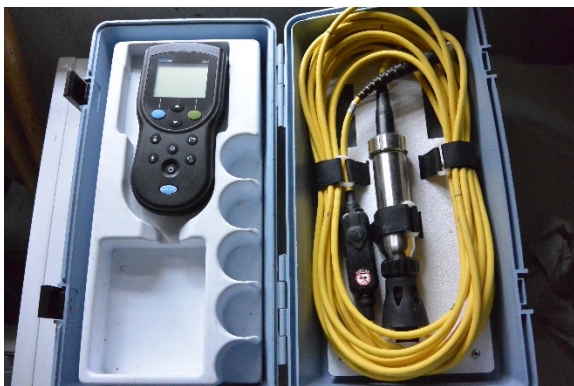
Figur 13. Syreprovtagaren är en HACH HQ 30d flexi med 10 meters kabel och mätsond.
